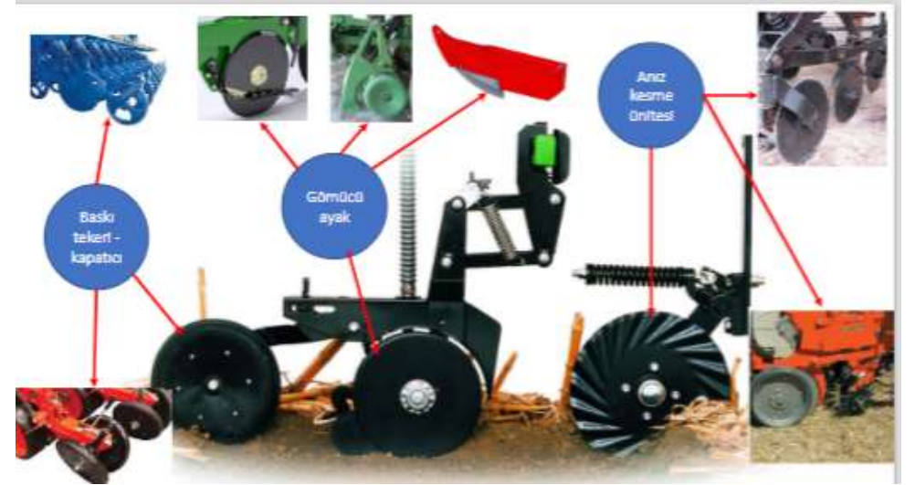
Şekil 1. Anıza doğrudan ekim makinası ünitelerinin makina üzerindeki dizilişi (ASAE, 2006b).
