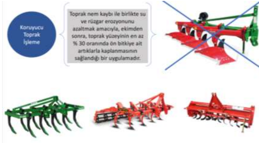
Şekil 3. Koruyucu toprak işlemede kullanılan ve kullanılmayacak olan toprak işleme alet ve makineleri
