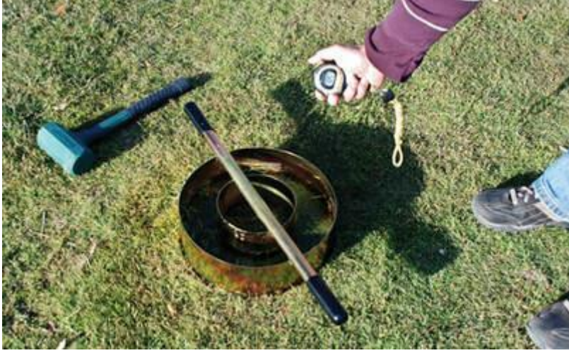
Şekil 3.8. İnfiltrasyon testinin yapılması (Kaynak: https://americangeoservices.com/soil-infiltration-testing.html , Erişim:29.09.2023)
