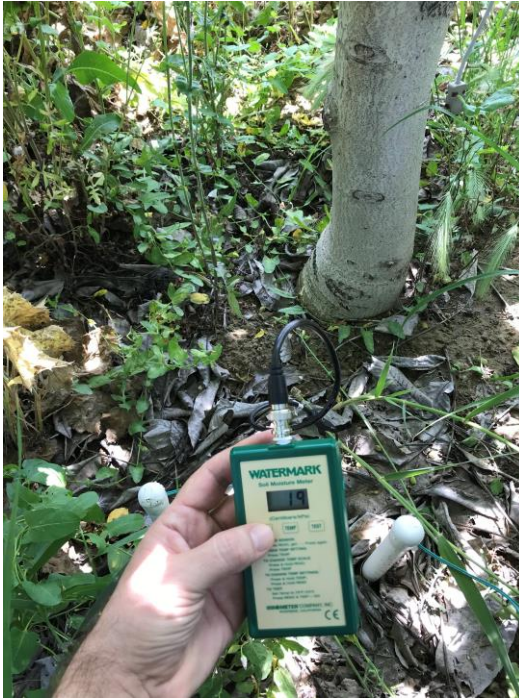
Şekil 3.5. Elektriksel direnç blokları (Watermark) Foto:Erhan GÖÇMEN
