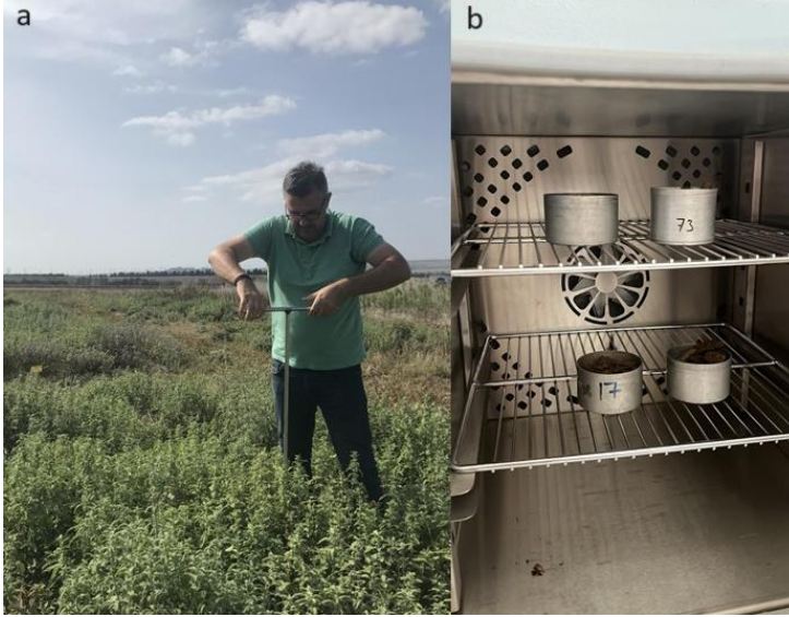
Şekil 3.3. a-Örneğin burgu ile alınması, b-örneğin etüvde kurutulması (Foto:Erhan GÖÇMEN)
